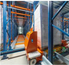
IN COMBINATION WITH STACKER CRANES, THE PALLET SHUTTLE SYSTEM CAN REACH A STORAGE HEIGHT OF UP TO 40 M.
